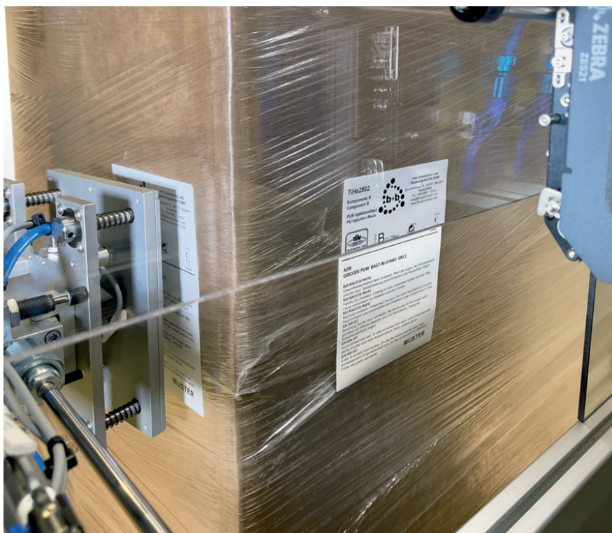
Abbildung 3: Der PAE Palettenetikettierer ist ein innovatives Druck- und Spendesystem, das mit pneumatischen und elektrischen Verfahrensrachsen bis zu drei Seiten einer Palette auszeichnen kann
