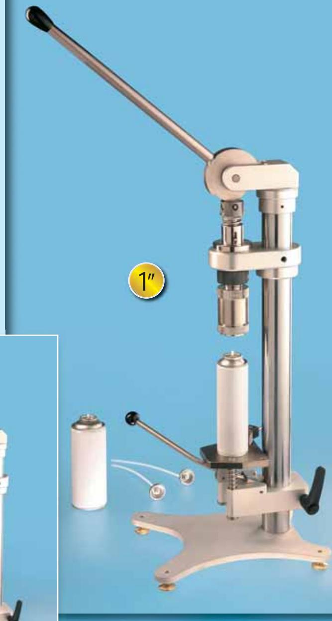
**AP79L Semplice ed economica, adatta ad operazioni di laboratorio, può essere impiegata per la produzione di piccoli quantitativi. La rapida sostituzione della testa (caratteristica comune a tutte le macchine di nostra produzione), consente di poter passare rapidamente da una misura di aggraffatura all'altra. Questo modello, montando la testa specifica, consente l'aggraffatura di valvole aerosol da 1".**
